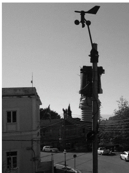
Εικόνα 3 Ο μετεωρολογικός σταθμός του ΕΑΑ στο Κομπότι και δεξιά μία πολύ ωραία φωλιά πουλιού στο βροχόμετρο η οποία μέχρι να απομακρυνθεί είχε ως αποτέλεσμα να καταγράφονται λανθασμένες μετρήσεις (σε κάθε περίπτωση προβλήματα και βλάβες καταγράφονται, ώστε να λαμβάνονται υπόψη στην επεξεργασία των δεδομένων, π.χ.:
